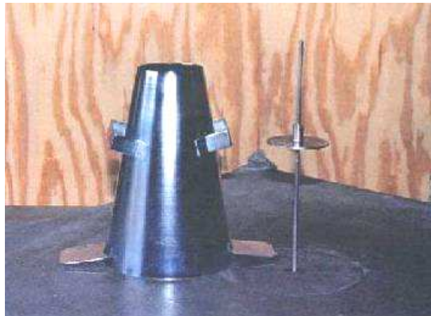
Fig 4.8. Vista de el cono de slump, la base y los elementos adicionales.
