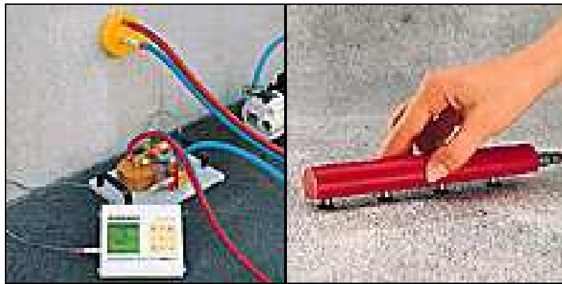
Fig. 5.26. Ensayo de permeabilidad y resistividad eléctrica con el equipo Torrent.
