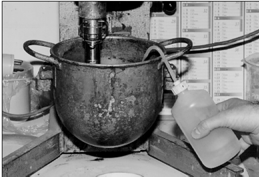
Fig. 2.15. Ajuste del agua en el ensayo de demanda de agua.
