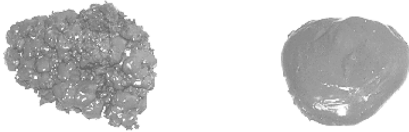
Fig. 2.14. Del estado de floculos húmedos al estado de pasta homogénea
