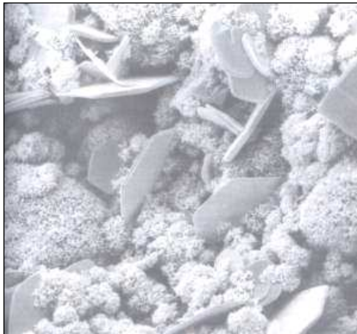
Fig. 2.10. Pasta de cemento hidratada: \text{Ca}(\text{OH})_2 y C-S-H.
