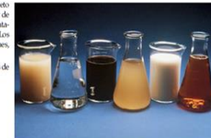
Fig. 6-1. Aditivos líquidos, de la izquierda hacia la derecha: aditivo anti-deslave, reductor de retracción, reductor de agua, agente espumante, inhibidor de corrosión e incorporador de agua. (MG12188)
