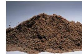
Fig. 5-1. Primer plano de agregado fino (arena). (IMG12185)
