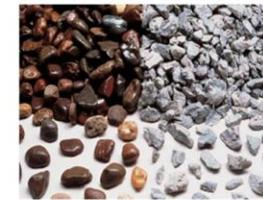
Fig. 5-2. Agregado grueso. Grava redondeada (izquierda) y piedra triturada (derecha). (IMG12184)
