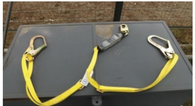
Figura 12.12 Estrobo de seguridad de vida con absorbedor de impacto.
