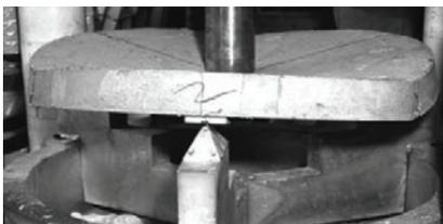
Figura 10.13 Panel ASTM C1550. Se muestra un ensayo de carga en desarrollo.
