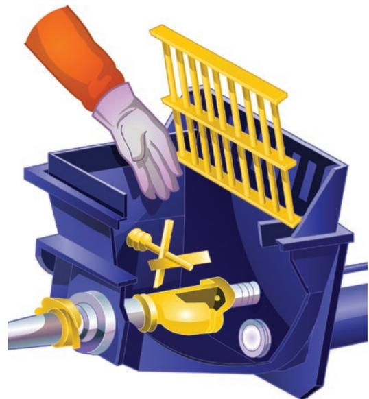
Figura 12.7 Ninguno de los operadores debe levantar la rejilla o parilla de la bomba de hormigón y menos intentar meter la mano o movilizar algún material atrapado en los agitadores o manilla "S".
