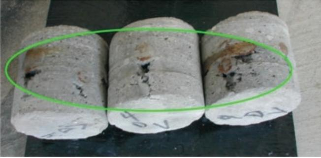
Figura 8.7 Testigos extraídos que muestran el mal encapsulamiento de las barras.
