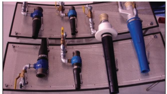
Figura 6.14 Tipos de boquillas.
