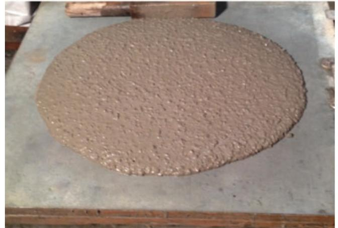
Figura 10.4 Imágenes del resultado de ensayo de la mesa de sacudidas.
