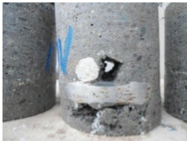
Figura 2.4. Testigo que muestra el mal encapsulado de las barras, parte del proceso de examinación de ACI 506.
