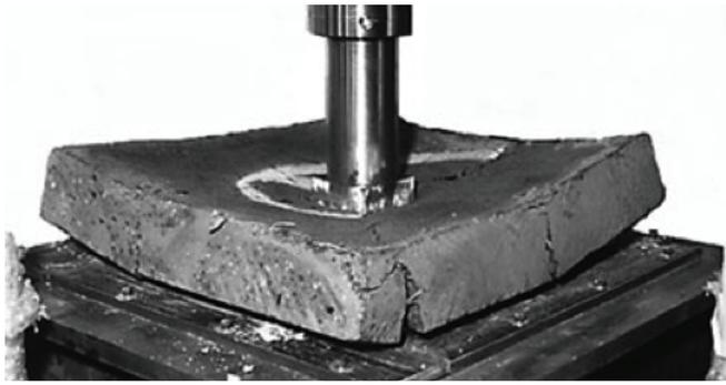
Figura 10.11 EN 14488-5 Ensayo panel cuadrado para absorción de energía.
