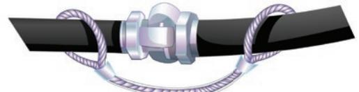
Figura 12.6 Las líneas de combustible y aire deben llevar en forma adicional una cuerda metálica que permita contener la línea en caso que falle la unión.
