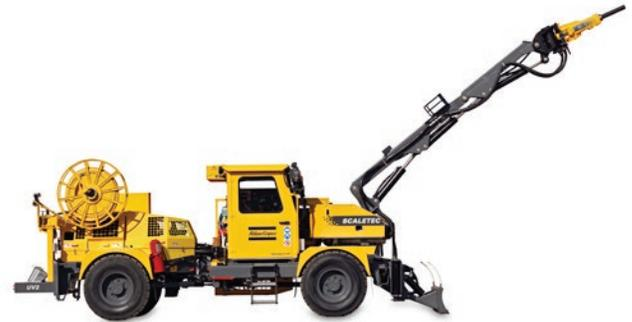
Figura 8.22. Variedad de equipos robotizados para shotcrete.
