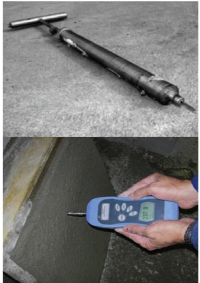
Figura 10.9 Modelos de penetrómetro tradicional para hormigón y uno más moderno con lectura digital. En ambos casos el principio de lectura es el mismo, así como la necesidad de calibración.
