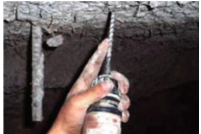
Figura 8.27b Control de espesor por perforación.
