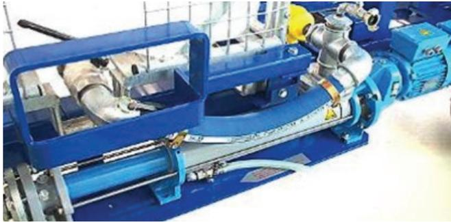
Figura 6.10 Bomba dosificadora tipo mono (bomba de tornillo)
