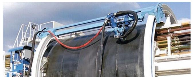
Figura 8.30 Brazo para aplicación de shotcrete montado en una TBM.
