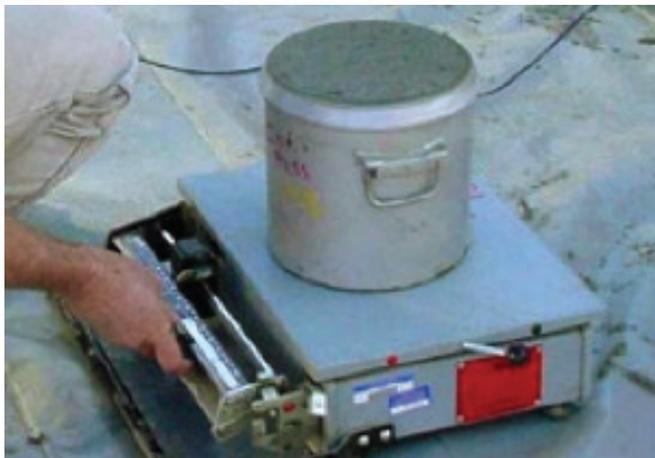
Figura 10.6 Ensayo de densidad del hormigón fresco.
