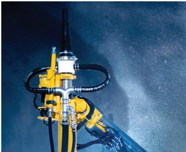
figura 6.11 Cabezal tipo en un equipo de proyección de hormigón remoto
