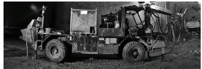
Figura 6.9 Equipo de proyección usado en obras de minería subterránea y obras civiles e infraestructura.
