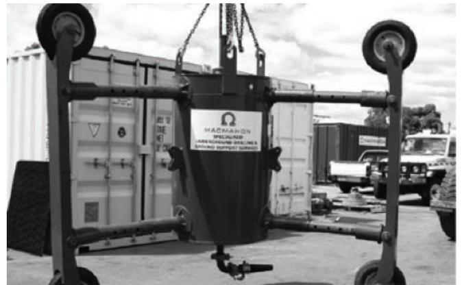
Figura 8.29 Equipo de shotcrete para shaft.
