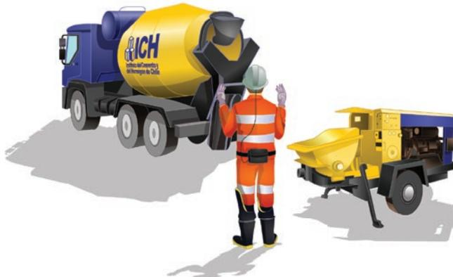
Figura 12.8 En la recepción del hormigón por parte del operador se debe tener en cuenta visibilidad durante las labores de retroceso del equipo, hasta la completa detención, nunca ubicarse entre el capacho y el equipo de transporte.
