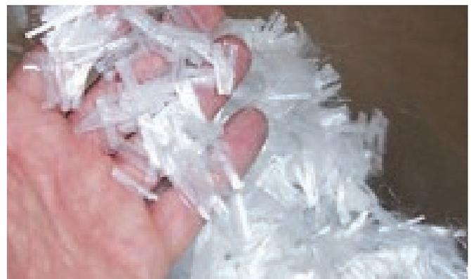
Figura 4.2 Microfibras sintéticas (de especial uso en hormigón proyectado para la protección de incendios).
