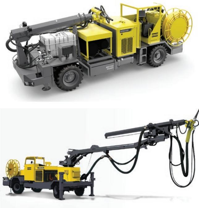
obra comparado con shotcrete manual, un mejor control de productos y producción, disminución en la carga efectiva de trabajo asociado a las faenas de shotcrete, disminución del rebote y una mejor condición de trabajo para la cuadrilla que acompaña al operador.
