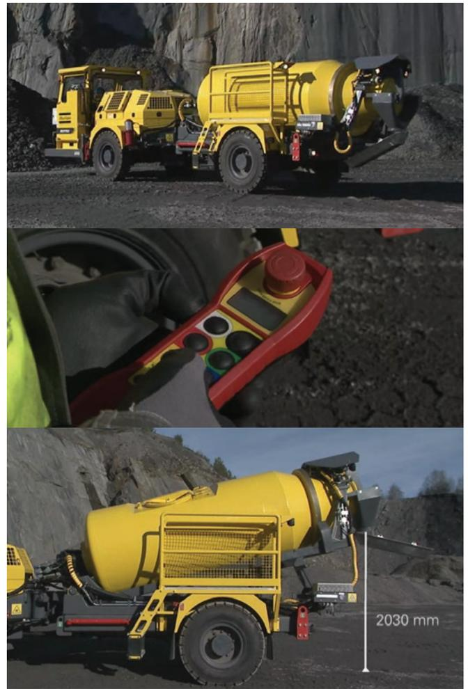
Figura 8.24 Nuevos desarrollos en camión agitador y mixer, con control de descarga.
