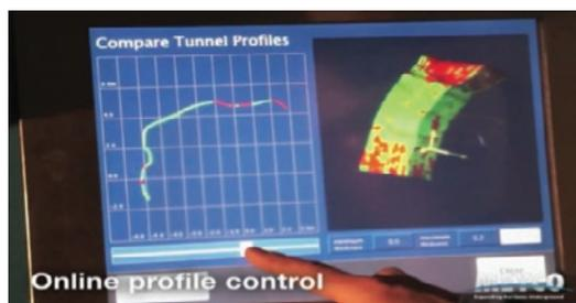
Figura 10.22 Pantalla que permite visualizar el perfil del túnel antes y después de la proyección, indicando las áreas que falta espesor.
