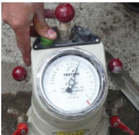
Figura 11.7 Medición del contenido de aire.
