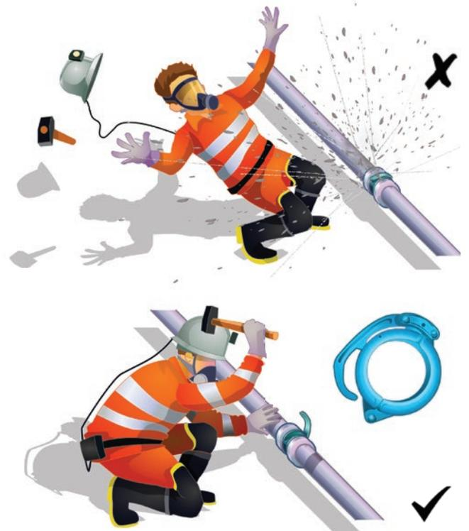
Figura 12.5 El operador debe velar que todas las conexiones de la línea de transporte de hormigón estén debidamente cerradas.
