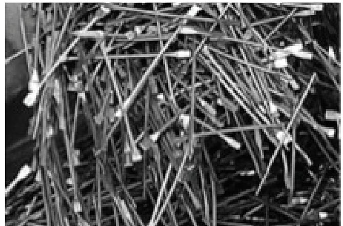
Figura 4.1 Fibra de acero de extremo aplanado.
