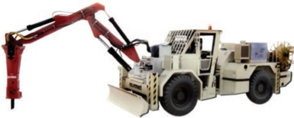
Figura 8.2a Equipo de acuñaamiento mecánico.
