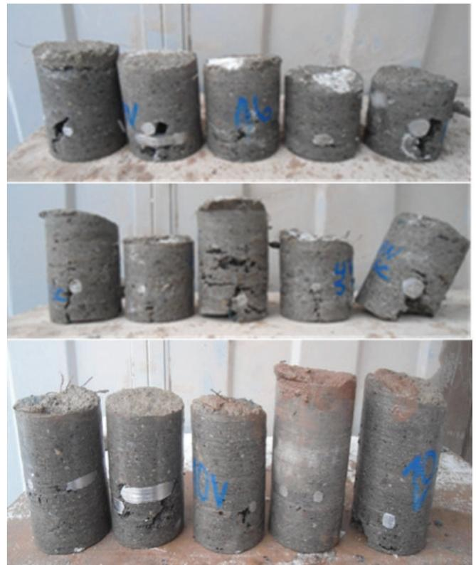
Figura 13.3 Ejemplo de testigos evaluados mediante la distribución de armaduras para un proceso de certificación de pitoneros bajo el estándar ACI 506.3R.
