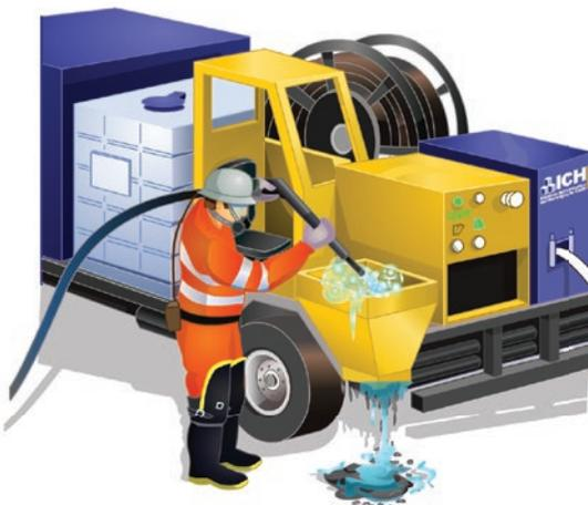
Figura 12.9 Las operaciones de limpieza de los equipos deben ser realizadas con estos apagados y sin conexión eléctrica.
